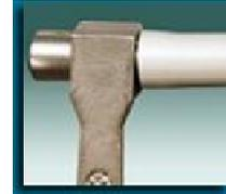
Se abocarda el tubo GLADIATOR de la misma forma que se haría con un tubo de polietileno reticulado BARBI (realizar la operación en varias fases)
