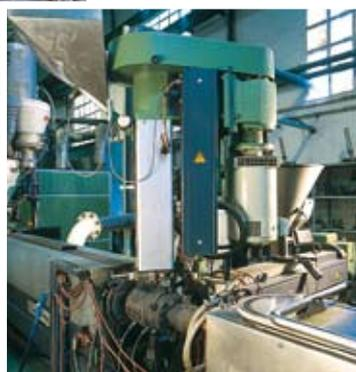
Трубы **BARBI** из сшитого полиэтилена производятся по технологии Monosil, берущей начало из оптоволоконной промышленности, которая гарантирует устойчивость труб давлению на 35% выше, чем в других производственных системах. Высокое сопротивление по методу Monosil достигается благодаря тому, что соединения между цепочками полиэтилена трехмерные, т.е. более крепкие, чем соединения, образованные другими производственными методами, в которых соединения ровные.
