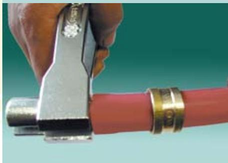
Чтобы вставить трубу в фитинг нужно расширить конец трубы, чтобы можно было использовать инструмент, который называется калибратор (код ABOCARD).
