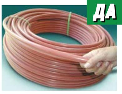
2. Чтобы сменить направление нужно использовать естественную кривизну труб. Допустимый максимальный радиус кривизны – 10 кратный внешний диаметр или 5 кратный внешний диаметр трубы из алюминия.
